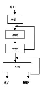
图2 主要有色金属选矿工艺流程示意图
