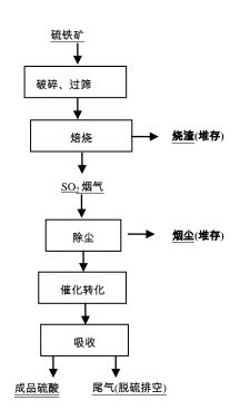
图6 硫铁矿制酸工艺流程示意图
