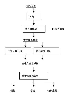
图 9 铜阳极泥的处理工艺流程示意图
