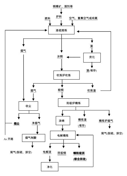
图 3 火法炼铜生产工艺流程示意图
