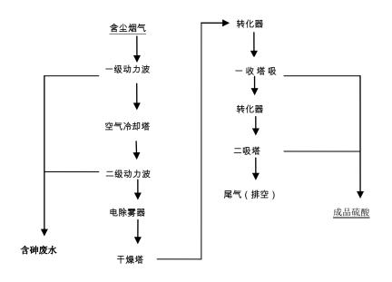
图7 冶炼烟气制酸工艺流程图(常压接触法)
