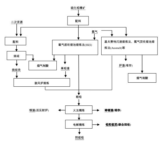
出粗铅、高铅渣和  $SO_2$  烟气,如已工业应用的氧气底吹熔池熔炼法(SKS 等)和闪速熔炼的基夫赛特熔炼法等(图 4 )。
