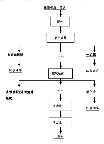
图 8 铅阳极泥火法处理工艺流程示意图
