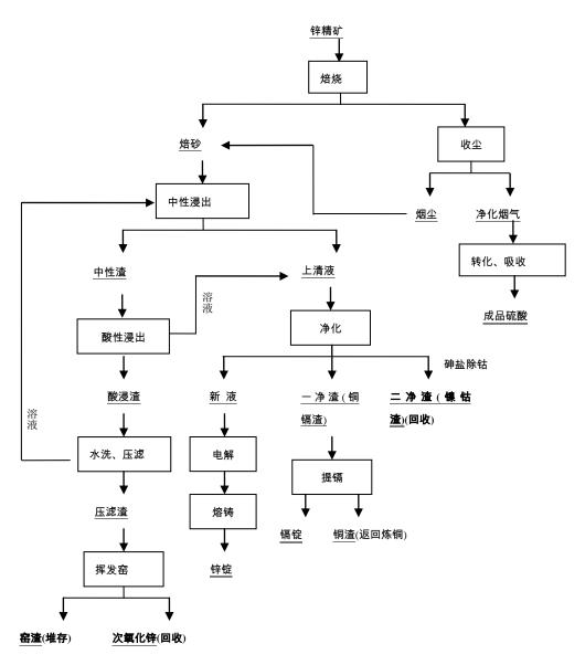
图 5 锌精矿传统冶炼工艺流程示意图
