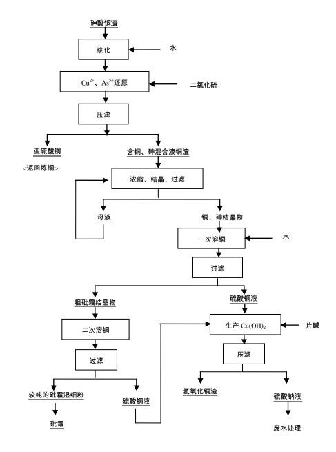
图10 硫酸铜渣分离铜、砷生产三氧化二砷流程示意图
